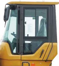
Интегрированная закрытая каркасная кабина обеспечивает отличный обзор и оснащена кондиционером и механическим подпрессоренным сиденьем с высокой спинкой, что повышает комфорт оператора.
