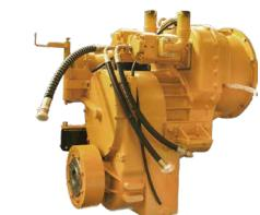
Трансмиссия оснащена немецкой коробкой передач ZF 4BP210, которая отличается долговечностью и надежностью, что обеспечивает длительный срок службы. Использование технологии электронного управления переключением передач позволяет рабочему рычагу иметь функцию KD (Сброс), что обеспечивает эффективное переключение между второй и первой передачей.
