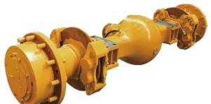
Корпус моста имеет оптимизированную конструкцию за счет увеличения поперечного сечения, при этом также усилен опорный подшипник ступицы, что позволяет переднему мосту выдерживать нагрузку до 40 тонн. Главный редуктор и ступицы колес также усилены, что увеличивает срок их службы на 30%.
